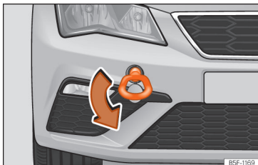
Fig. 48 Paraurti anteriore destro: occhiello di traino avvitato.
