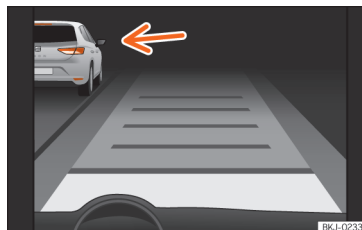
Fig. 248 Sul display del quadro strumenti: ACC attivo, veicolo rilevato sulla sinistra
