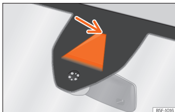
Fig. 251 Nel parabrezza: area del campo visivo della telecamera del dispositivo di assistenza per il mantenimento della corsia.
