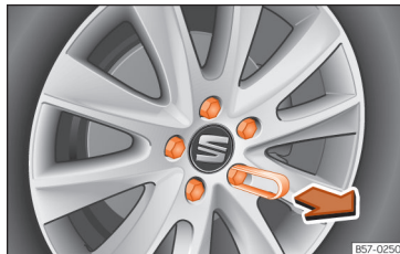
Fig. 36 Ruota: viti della ruota con tappi.
