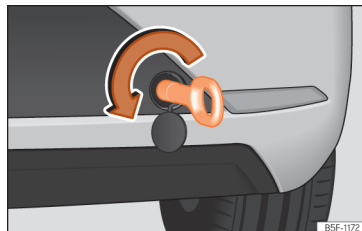
Fig. 50 Paraurti posteriore destro: occhiello di traino avvitato.
