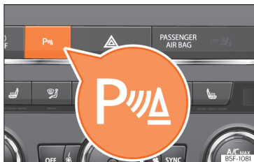
Fig. 261 Console centrale: tasto dell'assistenza per il parcheggio.
