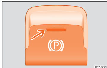
Fig. 255 Nella parte inferiore della console centrale: tasto del freno di stazionamento elettronico.
