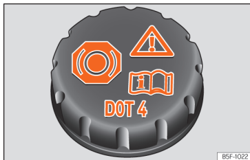
Fig. 291 Vano motore: tappo del serbatoio del liquido dei freni.
