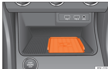
Fig. 223 Sulla console centrale: alloggiamento per il collegamento del telefono cellulare.
