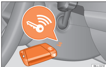
Fig. 226 A destra del piantone dello sterzo: avviamento di emergenza.
