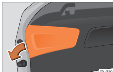
Fig. 67 Rimuovere la copertura del portellone posteriore.
