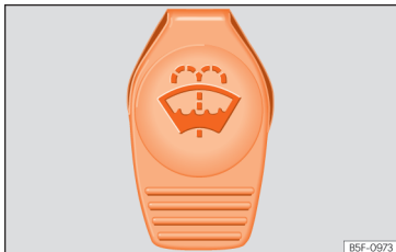
Fig. 292 Nel vano motore: tappo del serbatoio del tergicristalli.
