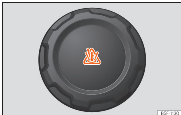
Fig. 290 Vano motore: tappo del serbatoio di compensazione del liquido di raffreddamento.
