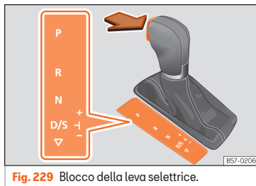
Fig. 229 Blocco della leva selettoria.
