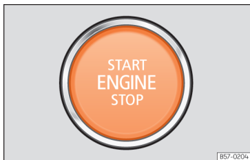
Fig. 225 Nella parte inferiore della console centrale: pulsante di avviamento.
