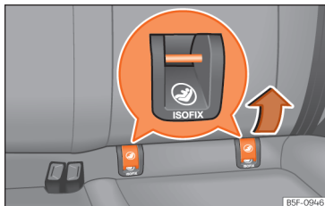
Fig. 28 Sedile posteriore: occhielli di fissaggio del sistema ISOFIX.
