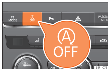
Fig. 227 Console centrale: tasto del sistema Start/Stop.
