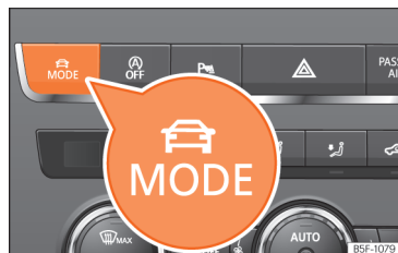
Fig. 234 Consolle centrale: tasto MODE. È possibile scegliere tra Normal, Sport, Eco, Comfort e Individual. »
