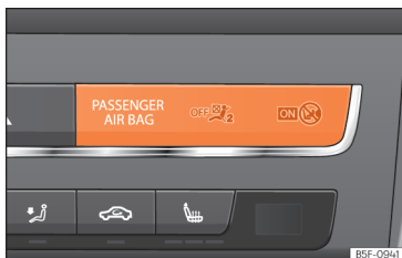
Fig. 18 Cruscotto: spia della disattivazione degli airbag del passeggero anteriore.
