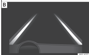
Fig. 252 Sul display del quadro strumenti: indicazione sul display del dispositivo di assistenza per il mantenimento della corsia [esempio 1].
