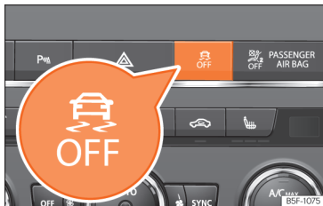
Fig. 258 Consolle centrale: Tasto per attivare/disattivare l'ESC e l'ASR
