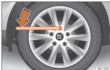
Fig. 38 Cambio di una ruota: allentare le viti della ruota.
