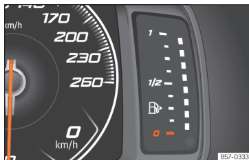
Fig. 80 Quadro strumenti digitale: indicatore del livello del carburante.
