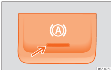
Fig. 257 Nella parte inferiore della console centrale: tasto della funzione Auto Hold.
