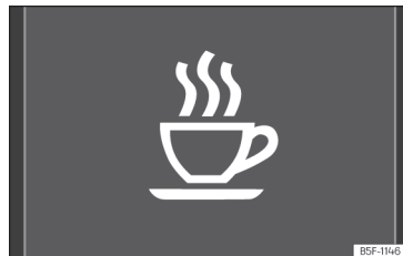
Fig. 77 Sul display del quadro strumenti: simbolo del riconoscimento della stanchezza del conducente.
