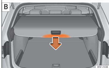
Fig. 139 Nel bagagliaio: srotolare e arrotolare il pianale.
