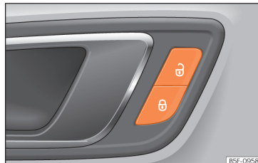
Fig. 97 Porta del conducente: interruttore della chiusura centralizzata.
