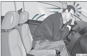
Fig. 6 Il conducente che non indossa la cintura di sicurezza viene scaraventato in avanti
