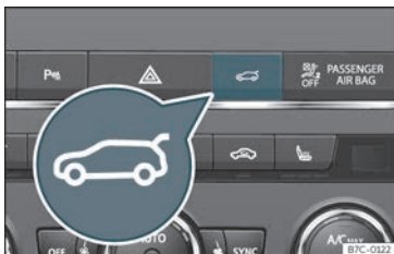
Fig. 79 Console centrale: tasto per aprire e chiudere il portellone posteriore.
