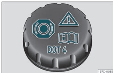
Fig. 261 Vano motore: tappo del serbatoio del liquido dei freni.
