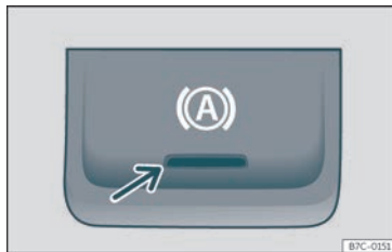
Fig. 231 Nella parte inferiore della console centrale: tasto della funzione Auto Hold.
