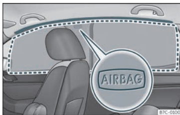
Fig. 20 Posizione degli airbag per la testa.
