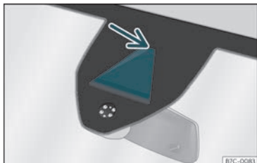
Fig. 222 Nel parabrezza: area del campo visivo della telecamera del dispositivo di assistenza per il mantenimento della corsia.
