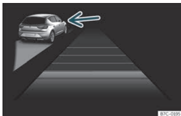
Fig. 219 Sul display del quadro strumenti: ACC attivo, veicolo rilevato sulla sinistra
