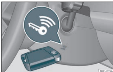
Fig. 198 A destra del piantone dello sterzo: avviamento di emergenza.
