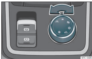
Fig. 204 Consolle centrale: Manopola di comando (Driving Experience button).
