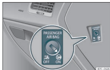
Fig. 14 Interruttore a chiave per l'attivazione e la disattivazione dell'airbag del passeggero.
