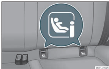
Fig. 24 Sedile posteriore: occhelli di fissaggio ISO-FIX/i-Size.
