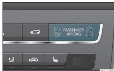
Fig. 15 Cruscotto: spia della disattivazione degli airbag del passeggero anteriore.
