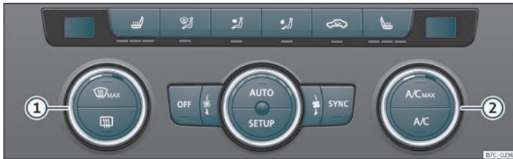
Fig. 122 Sulla console centrale: comandi del Climatronic.
