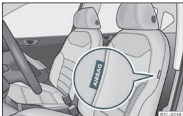
Fig. 18 Airbag laterale all'interno del sedile del conducente.
