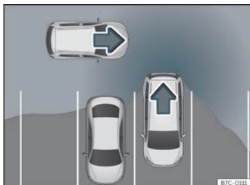
Fig. 229 Rappresentazione schematica dell'assistente di uscita dal parcheggio: zona vigilata attorno al veicolo che sta uscendo dal parcheggio.
