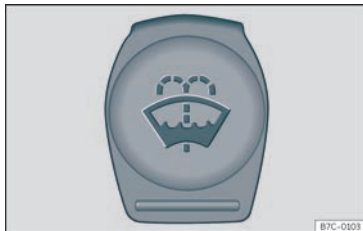
Fig. 262 Nel vano motore: tappo del serbatoio del tergcristalli.
