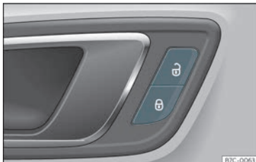
Fig. 70 Porta del conducente: interruttore della chiusura centralizzata.
