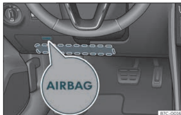
Fig. 16 Sul lato conducente: posizione dell'airbag per le ginocchia.
