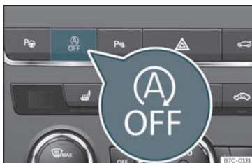
Fig. 199 Console centrale: tasto del sistema Start/Stop.
