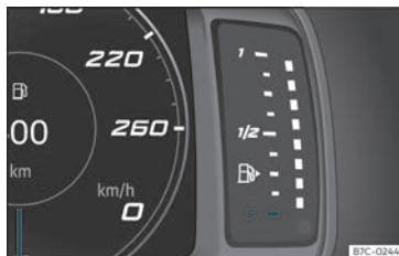
Fig. 59 Indicatore del livello del carburante.
