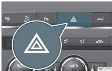
Fig. 90 Cruscotto: interruttore lampeggio di emergenza.
