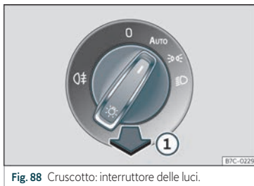
Fig. 88 Cruscotto: interruttore delle luci.
