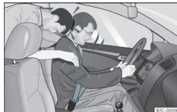
Fig. 7 Se non indossa la cintura, il passeggero seduto sul sedile posteriore viene scagliato in avanti, colpendo il conducente (che invece indossa la cintura)
