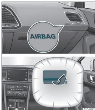
Fig. 13 Airbag del passeggero sul cruscotto.
