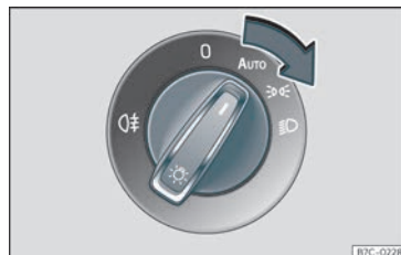
Fig. 87 Cruscotto: interruttore delle luci.
