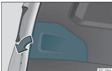
Fig. 49 Portellone posteriore aperto: estrarre il coperchio.
