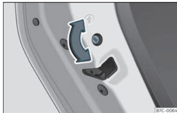
Fig. 76 Sicura per bambini della porta sinistra.
