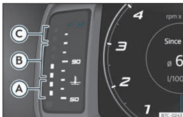
Fig. 60 Indicatore della temperatura del liquido di raffreddamento del motore.
