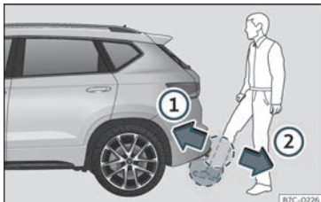
Fig. 80 Portellone del bagagliaio con apertura controllata da sensore (Easy Open).
