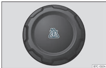
Fig. 260 Vano motore: tappo del serbatoio di compensazione del liquido di raffreddamento.
