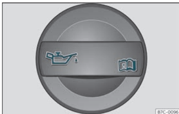
Fig. 258 Vano motore: tappo del bocchettone di rifornimento dell'olio motore.
