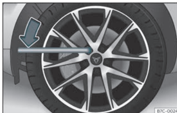
Fig. 37 Cambio di una ruota: allentare le viti della ruota.
