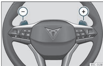
Fig. 143 Volante: leve per il cambio automatico.
