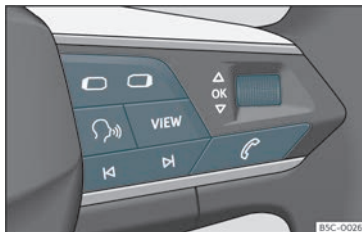
Fig. 60 Lato destro del volante multifunzione: tasti per l'utilizzo dei menu e delle indicazioni informative del quadro strumenti (a seconda della versione).
