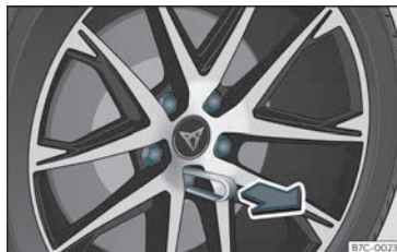
Fig. 35 Ruota: viti della ruota con tappi.
