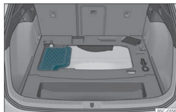
Fig. 211 Alloggiamento della batteria nel bagagliaio
