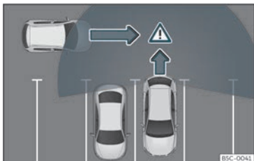
Fig. 169 Rappresentazione schematica dell'assistente di uscita dal parcheggio: zona vigilata attorno al veicolo che sta uscendo dal parcheggio.
