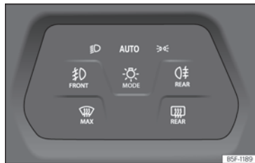
Fig. 89 Cruscotto: interruttore delle luci.
