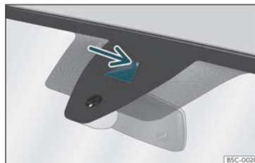
Fig. 147 Nel parabrezza: area del campo visivo della telecamera del dispositivo di assistenza per il mantenimento della corsia.
