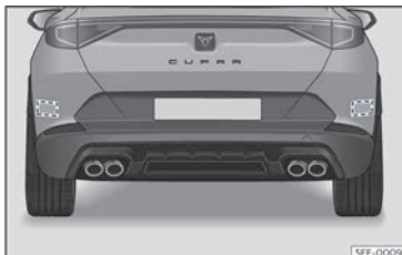
Fig. 148 Vista posteriore del veicolo: zone dei sensori radar.
