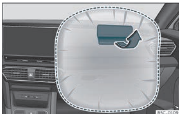
Fig. 14 Airbag del passeggero sul cruscotto.
