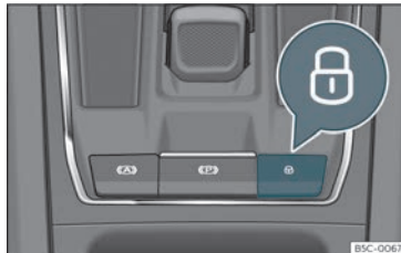
Fig. 75 Sulla console centrale: interruttore della chiusura centralizzata
