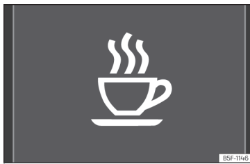
Fig. 53 Sul display del quadro strumenti: simbolo del riconoscimento della stanchezza del conducente.
