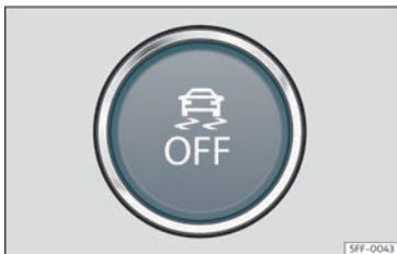
Fig. 174 Nella parte inferiore della console centrale: tasto per attivare/disattivare l'ESC
