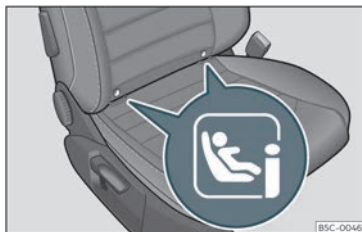
Fig. 28 Sedile passeggero anteriore: occhielli di fissaggio ISOFIX/iSize.
