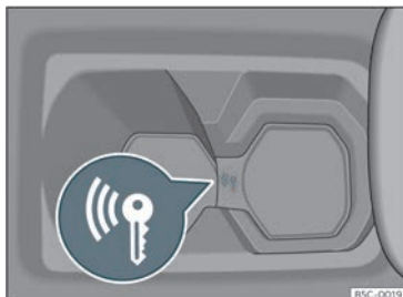
Fig. 139 Sulla console centrale: avviamento di emergenza.
