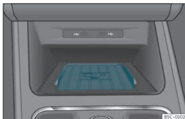
Fig. 135 Sulla console centrale: alloggiamento per il collegamento del telefono cellulare.
