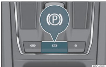
Fig. 172 Nella parte inferiore della console centrale: tasto del freno di stazionamento elettronico.
