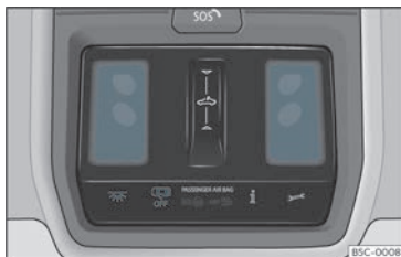
Fig. 92 Dettaglio del rivestimento del tetto: illuminazione anteriore dell'abitacolo.
