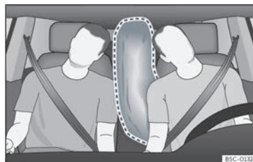
Fig. 20 Airbag centrale completamente gonfiato (area di spiegamento).
