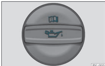
Fig. 204 Vano motore: tappo del bocchettone di rifornimento dell'olio motore.
