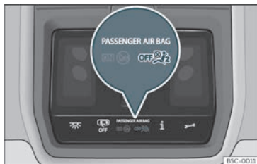
Fig. 16 Nella console del tetto: spia della disattivazione degli airbag del passeggero anteriore.
