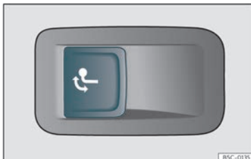
Fig. 185 Sul lato sinistro del bagagliaio: tasto per sbloccare il gancio del rimorchio.
