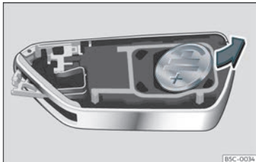
Fig. 73 Chiave del veicolo: estrarre la batteria.
