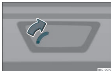
Fig. 85 Particolare del bagagliaio: sblocco di emergenza.
