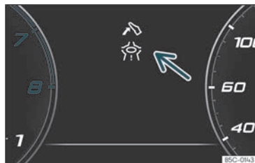
Fig. 55 Indicazione di assistenza per una guida eco-efficiente (rappresentazione schematica).
