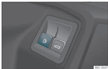
Fig. 196 Porta del conducente: sblocco dello sportellino del serbatoio.
