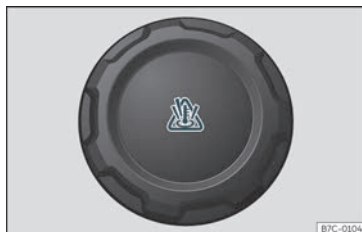
Fig. 207 Vano motore: tappo del serbatoio di compensazione del liquido di raffreddamento.
