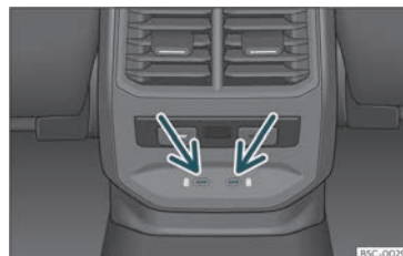
Fig. 137 Parte posteriore della console centrale: Connettori USB con funzione di presa di corrente.
