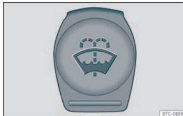
Fig. 209 Nel vano motore: tappo del serbatoio del tergcristalli.
