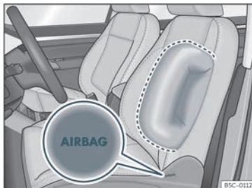
Fig. 21 Airbag laterale all'interno del sedile del conducente.
