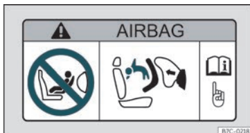
Fig. 25 Adesivo dell'airbag: nell'aletta parasole del lato passeggero
