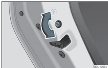
Fig. 80 Sicura per bambini della porta sinistra.
