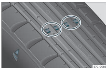
Fig. 213 Spessore del battistrada dello pneumatico: indicatori di usura.
