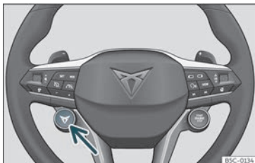
Fig. 144 Volante multifunzione*: tasto per modificare il profilo di guida.
