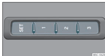
Fig. 104 Sul lato esterno del sedile del conducente: tasti di memoria.
