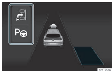
Fig. 175 Sul display del quadro strumenti: vista dell'assistente al parcheggio con visualizzazione ridotta.
