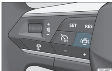
Fig. 62 Lato sinistro del volante multifunzione: chiave per i sistemi di assistenza alla guida (a seconda delle versioni).
