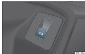
Fig. 83 Sulla porta del conducente: tasto per aprire e chiudere il portellone posteriore.
