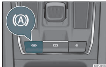
Fig. 173 Nella parte inferiore della console centrale: tasto della funzione Auto Hold.
