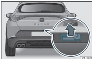
Fig. 81 Portellone posteriore: apertura dall'esterno.
