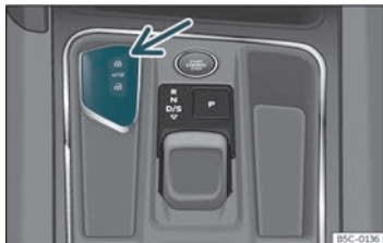
Fig. 70 Consolle centrale: alloggiamento della chiave di accensione.
