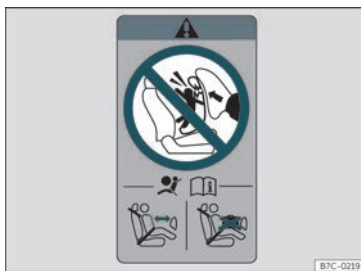
Fig. 26 Adesivo dell'airbag: nel telaio posteriore della porta lato passeggero
