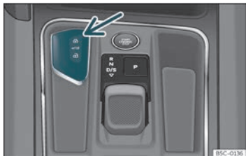
Fig. 66 Consolle centrale: alloggiamento della chiave di accensione.
