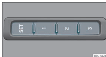
Fig. 100 Sul lato esterno del sedile del conducente: tasti di memoria.
