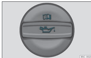
Fig. 187 Vano motore: tappo del bocchettone di rifornimento dell'olio motore.
