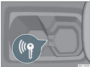
Fig. 135 Sulla console centrale: avviamento di emergenza.
