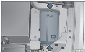
Fig. 48 Nel vano motore: coperchio della scatola dei fusibili.
