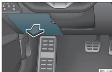
Fig. 47 Sul cruscotto, lato del conducente: coperchio della scatola dei fusibili.
