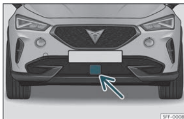
Fig. 140 Sul paraurti anteriore: sensore radar.
