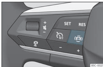
Fig. 58 Lato sinistro del volante multifunzione: chiave per i sistemi di assistenza alla guida (a seconda delle versioni).
