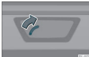
Fig. 81 Particolare del bagagliaio: sblocco di emergenza.
