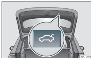
Fig. 78 Portellone posteriore: tasto per chiudere il portellone.
