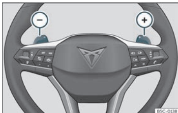
Fig. 138 Volante: leve per il cambio automatico.
