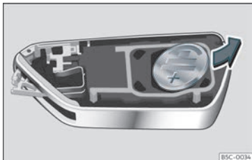
Fig. 69 Chiave del veicolo: estrarre la batteria.
