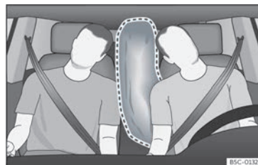
Fig. 20 Airbag centrale completamente gonfiato (area di spiegamento).
