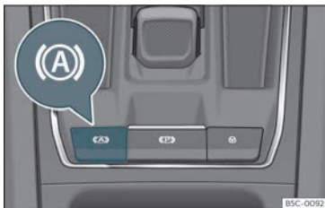
Fig. 168 Nella parte inferiore della console centrale: tasto della funzione Auto Hold.
