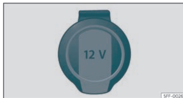
Fig. 121 Presa di corrente da 12 Volt: ① all'interno del bracciolo anteriore.
