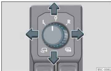
Fig. 93 Dettaglio della porta del conducente: comando per lo specchietto retrovisore esterno.
