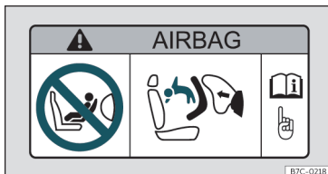
Fig. 25 Adesivo dell'airbag: nell'aletta parasole del lato passeggero
