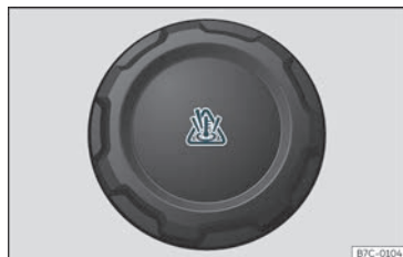
Fig. 189 Vano motore: tappo del serbatoio di compensazione del liquido di raffreddamento.
