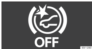
Fig. 150 Sul display del quadro strumenti: indicazione di Front Assist disattivato.
