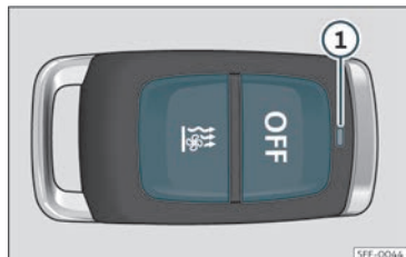
Fig. 125 Riscaldamento autonomo: telecomando a radiofrequenza.
