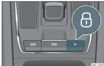
Fig. 71 Sulla console centrale: interruttore della chiusura centralizzata
