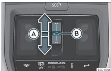
Fig. 83 Nel rivestimento interno del tettuccio: stato del tettuccio di vetro.
