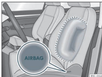
Fig. 21 Airbag laterale all'interno del sedile del conducente.
