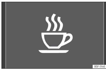
Fig. 52 Sul display del quadro strumenti: simbolo del riconoscimento della stanchezza del conducente.
