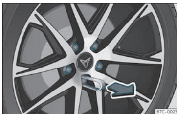
Fig. 35 Ruota: viti della ruota con tappi.
