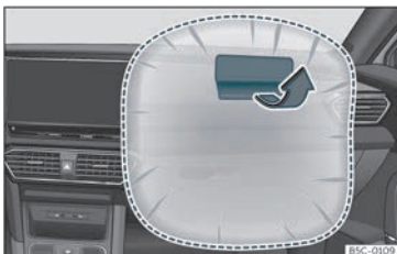
Fig. 14 Airbag del passeggero sul cruscotto.
