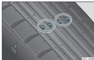
Fig. 194 Spessore del battistrada dello pneumatico: indicatori di usura.
