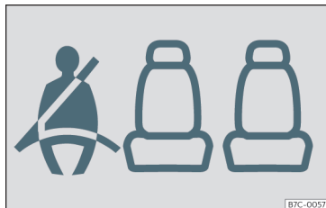
Fig. 5 Quadro strumenti: indicazione del sedile posteriore sinistro occupato e relativa cintura allacciata.
