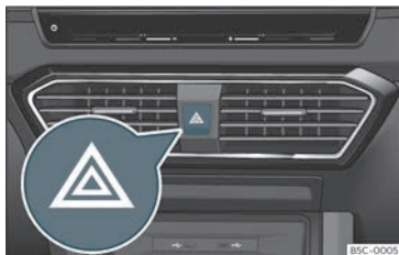
Fig. 87 Cruscotto: interruttore lampeggio di emergenza.
