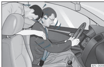
Fig. 8 Se non indossa la cintura, il passeggero seduto sul sedile posteriore viene scagliato in avanti, colpendo il conducente (che invece indossa la cintura)
