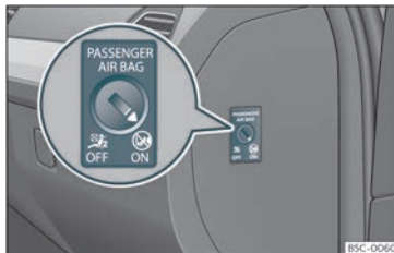
Fig. 15 Interruttore a chiave per l'attivazione e la disattivazione dell'airbag del passeggero.
