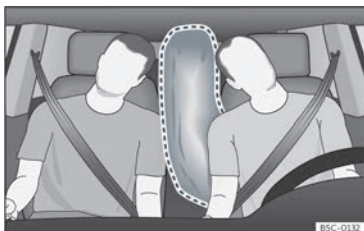
Fig. 20 Airbag centrale completamente gonfiato (area di spiegamento).
