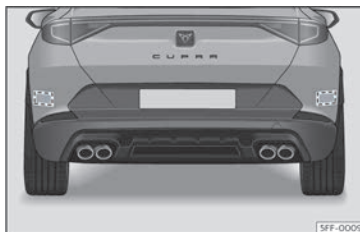
Fig. 143 Vista posteriore del veicolo: zone dei sensori radar.
