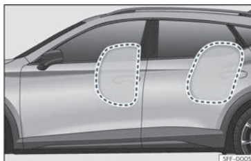
Fig. 22 Airbag laterali gonfiati completamente nel lato sinistro del veicolo.
