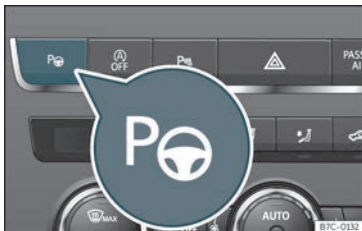
Fig. 177 Nella parte superiore della console centrale: tasto per inserire l'assistente di parcheggio.
