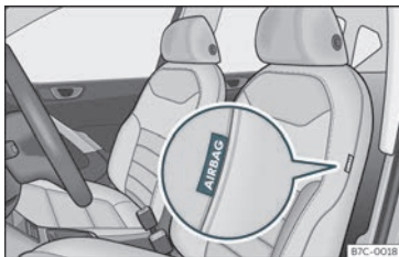
Fig. 19 Airbag laterale all'interno del sedile del conducente.
