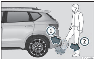
Fig. 85 Portellone del bagagliaio con apertura controllata da sensore (Easy Open).
