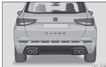
Fig. 151 Vista posteriore del veicolo: zone dei sensori radar.
