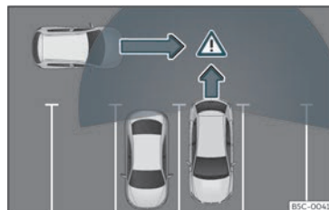
Fig. 174 Rappresentazione schematica dell'assistente di uscita dal parcheggio: zona vigilata attorno al veicolo che sta uscendo dal parcheggio.
