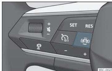
Fig. 64 Lato sinistro del volante multifunzione: chiave per i sistemi di assistenza alla guida (a seconda delle versioni).
