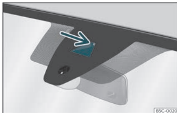
Fig. 150 Nel parabrezza: area del campo visivo della telecamera del dispositivo di assistenza per il mantenimento della corsia.
