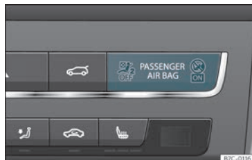
Fig. 16 Cruscotto: spia della disattivazione degli airbag del passeggero anteriore.
