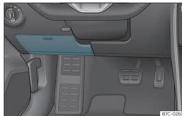
Fig. 45 Veicoli con guida a sinistra: coperchio della scatola dei fusibili sotto il cruscotto sul lato conducente
